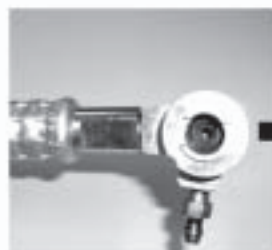
Foto 01 Con anillo de sellado (equivocado)
