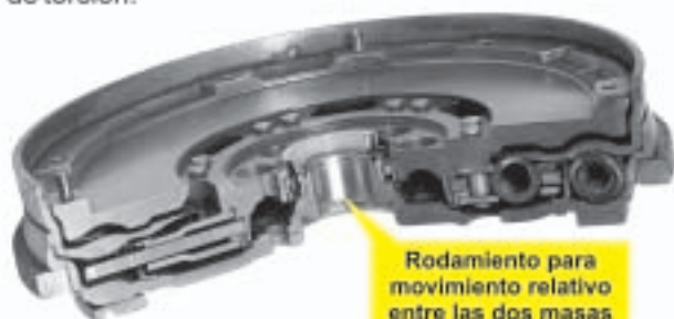
Corte de un volante doble masa
