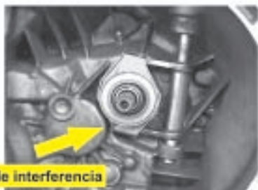
Horquillas sin pernos - incorrecto - (Figura 01)
