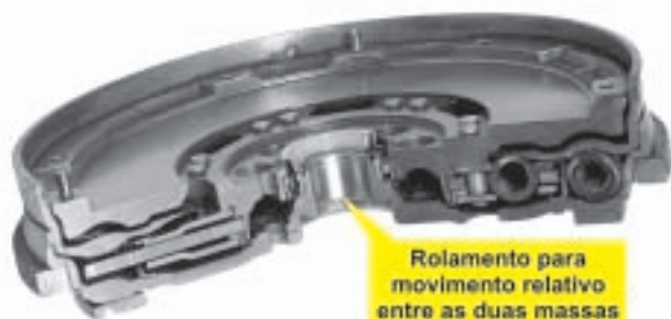
Corte de um volante Bi-massa
