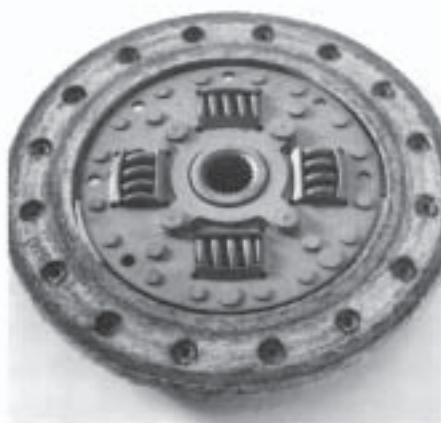
Revestimento do lado do volante apresenta desgaste somente nos diâmetros interno e externo
