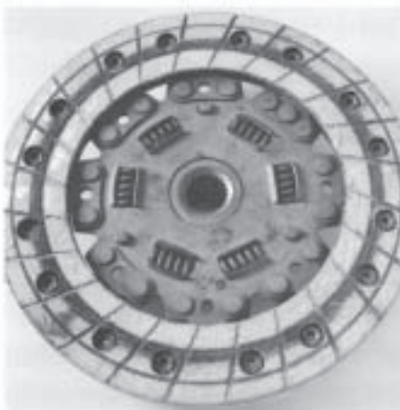
Sulcos acentuados no revestimento do lado do volante
